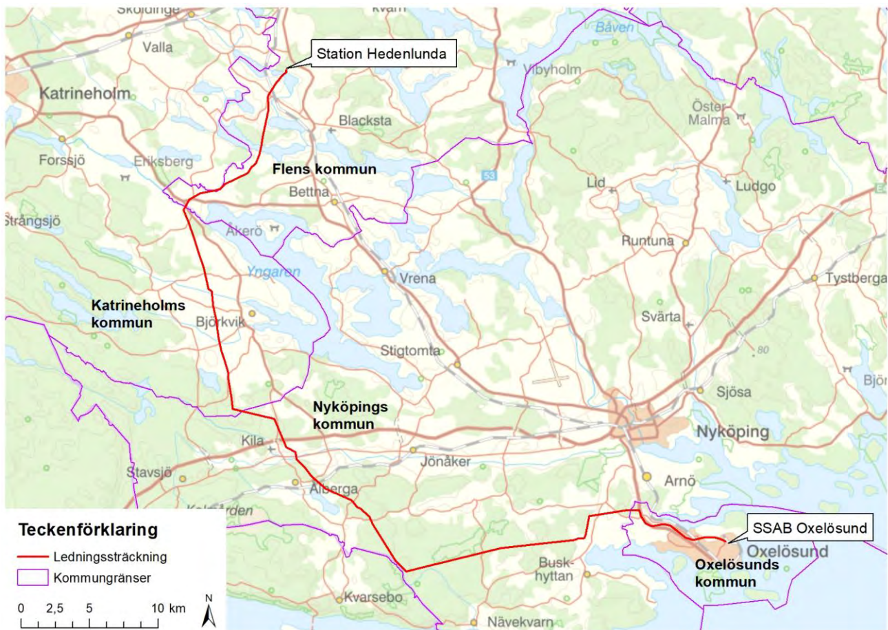
Figur 1. Översikt nya 130 kV ledningar mellan Hedenlunda och SSAB i Oxelösund
